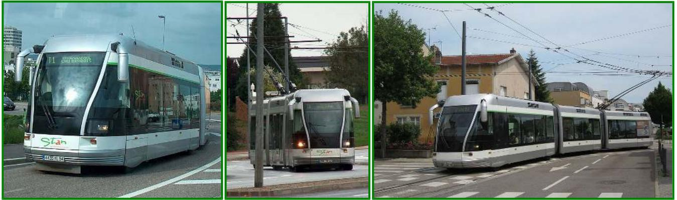
Le "trolley Stan" de Nancy. A gauche en mode bus, au centre en mode trolley, à droite en mode tram, guidé par un rail.
